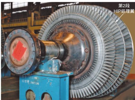
HIP再生化処理翼の実機組込み状況
