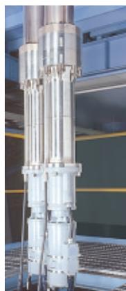
改良型制御棒駆動装置(シールレス型)
