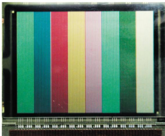
開発したカラー反射型記録保持型LCDの保持表示例
