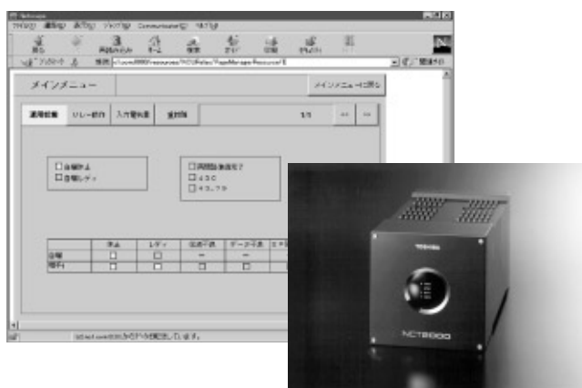
図6. 遠隔運用監視ブラウザ画面の例(左)とNCT(右) リレーユニットにNCU又はNCTを組み込むことで,汎用ブラウザによるリレーの遠隔運用監視を実現している。
