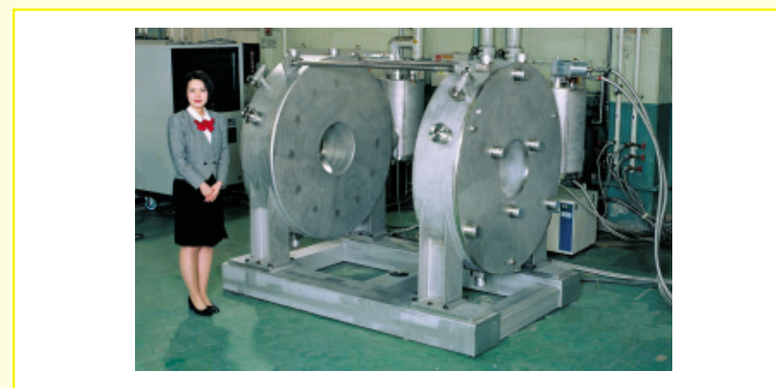
図2. 世界最大の高温超電導マグネット 単結晶上げ装置用の超電導磁石として、住友電気工業(株)、信越半導体(株)と共同で開発しました。線材総長は80 km、蓄積エネルギーは約1 MJです。
