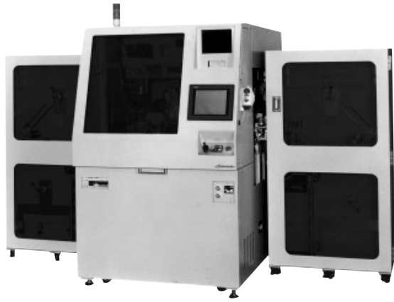
図2．高精度フリップチップボンダ TFC - 2000 COFのリールtoリール方式に対応した高精度フリップチップボンダである。 High-precision flip chip bonder
