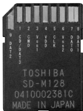
図1. SDカードの外形と端子位置 端子配置は、MMC( Multi Media Card )に上位互換性がある。 External view and terminal layout of SD card
