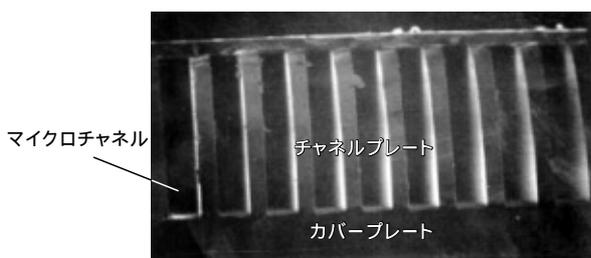
図4. マイクロチャンネルチップ断面 異方性エッチングによって形成された縦横比の大きなチャンネル断面(57 μm×350 μm)が複数並んでいる。
