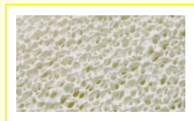
図1. 光触媒モジュール 三次元多孔質セラミック基体にTiO 2 をコーティングしたものです。
