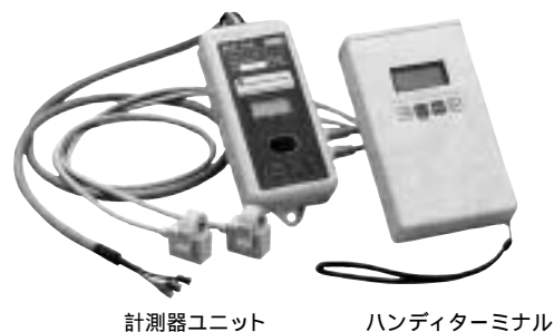
図6. フィーダ電力レコーダ 低圧回路に簡単に設置でき, 40日間のトレンドデータが収集できる。
