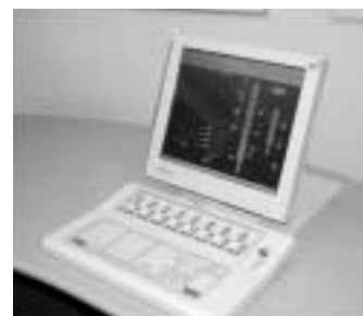
図9 . LCDタッチモニタ CRTに比べ、薄型、軽量となり、デスクのコンパクト化が実現できる。 LCD touch monitor
