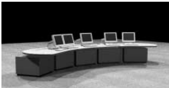
図8 . LCDを適用した操作室のレイアウト LCDを使用することによる操作室の省スペース化が実現できる。 Layout of operation room with LCDs
