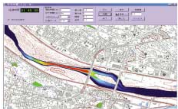
図6. 河川水質分散予測シミュレーション モデル河川上流端の中央部に, 異常水質が5分間だけ流入した場合の分散シミュレーションを示す。
