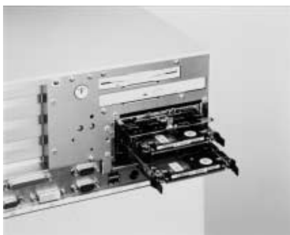
図9 . ホットスワップ対応ミラーリングディスク ミラーリングディスクはホットスワップに対応しており、オンライン動作中に交換が可能である。
