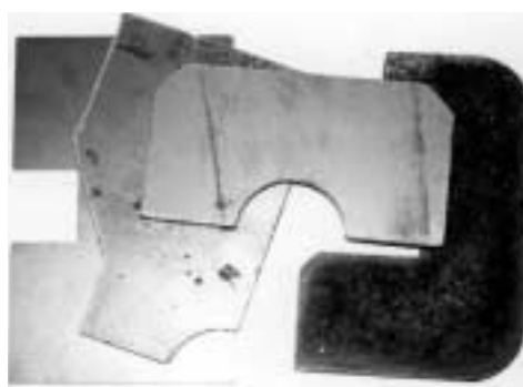
図1. 仕上げ作業の対象とするワークの形状例 直線や円弧から構成される二次元形状の、ガス切断後の鋼板ワークを示す。 Examples of workpieces
