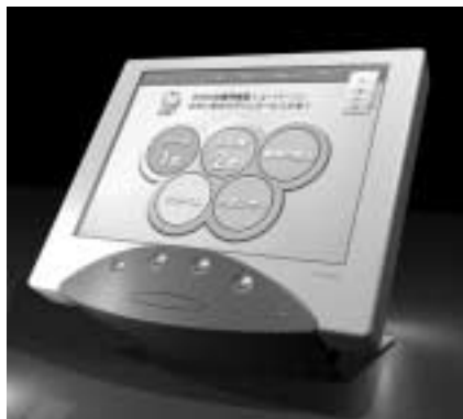
図2 . ホーム端末のデザインと操作画面 操作はタッチ式ディスプレイとメニュー形式で、だれにでも簡単に操作できるようにした機能試作品である。
