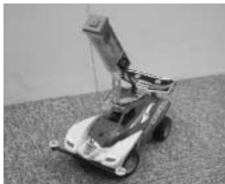
図7. 無線カメラを搭載したラジコン車 この車を使って人間が近づく場合(状況I)と、ロボットが動く場合(状況II)の画像列を収集した。 Radio-controlled model car with camera
