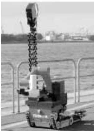
図5 原子力防災支援ロボット 階段昇降可能な走行台車に、センサやカメラアームを搭載し作業監視を行う。 Robotic system for nuclear facility emergency preparedness
