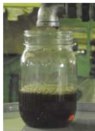
図4. 押出機から排出された分解物 ウレタン樹脂が完全に分解され、透明感のある液体となって押出機の出口から排出される。
