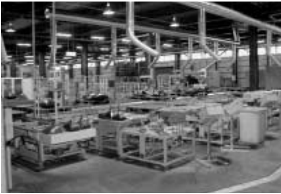
図3 . テレビ手分解テーブルとブラウン管搬送コンベア テレビは手作業にて分解し、ブラウン管はファンネルガラスとパネルガラスに分離する。
