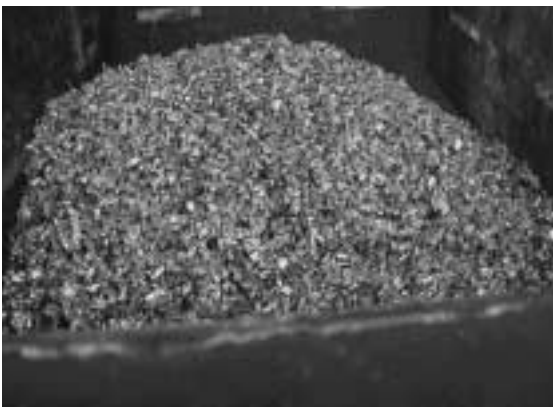
図4 . 磁力選別機で回収された鉄 洗濯機、エアコンを破碎し、磁力選別機にて鉄を選別する。鉄は価値物として引き取られる。 Iron collected with magnetic separator
