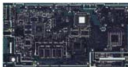
図9.6層ハロゲンフリーFR-4 PWB 6層ハロゲンフリーPWBは、青色のソルダーレジストをイメージカラーにしている。 Six-layer PWB fabricated using halogen-free FR-4
