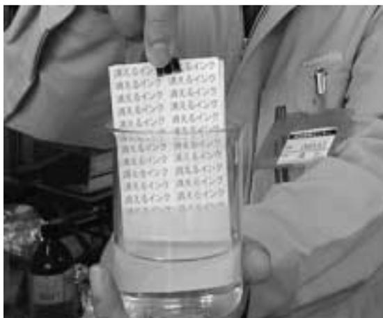
図4．溶剤消去実験 紙束の印刷物も、このように溶剤に浸(つ)けると瞬時に消える。
