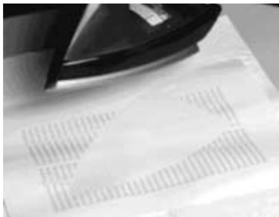
図5．アイロンによる熱消去実験 実用的には低温(130℃)で、100～1,000枚の紙を束にして同時に消去できる。
