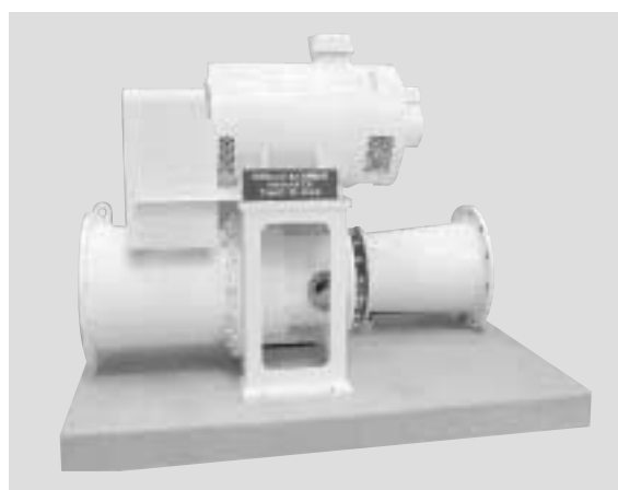
図4 . S型 Hydro-eKIDS TM 水車と発電機の一体化により、据付けはベースとの締結、水路配管とのフランジ接続だけで完了する。 S-type Hydro-eKIDS TM
