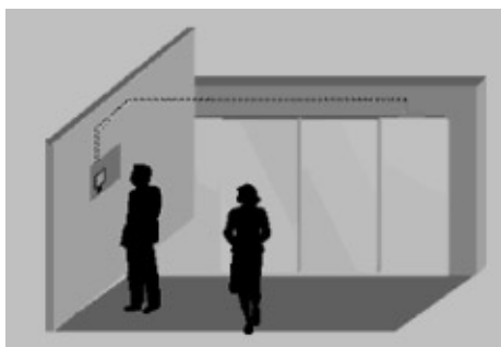
図2 . 入室管理システム 顔認識結果 + ID入力により,入室管理を行う。 Facility access control system
