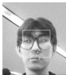
図6. 検出された顔領域と特徴点 顔領域から分離度フィルタにより瞳、鼻孔、口端を検出した。 Extracted face region and feature points
