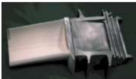
図5．最新TBCを施工したガスタービン1段動翼 翼表面にTBCを施工した。
