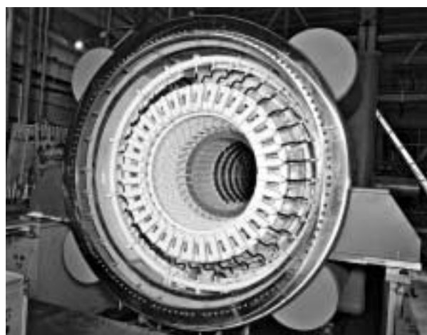
図3 . 固定子コイル 固定子コイルは、中空素線と中実素線で構成され、内部に水を通して冷却する。
