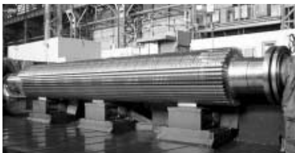
図2 . 回転子軸 軸材は、開発された高強度鍛造特殊鋼が使われている。
