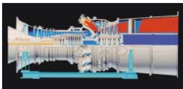
図4. H型ガスタービン組立図 蒸気冷却翼、単結晶材使用の初段動静翼、遮熱コーティングの塗布など、最先端の技術を適用している。
