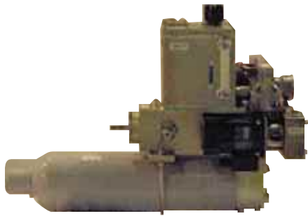
図4．オールインワン方式油圧操作機構 構成要素をすべてモジュール化し、接続配管を排した新型油圧操作機構である。 All-in-one type hydraulic operating mechanism
