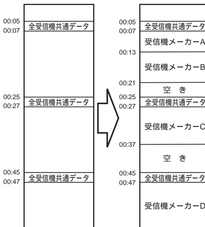
図4 . スケジューリング概要 全受信機共通データのスケジューリング後,各受信機ソフトウェアのスケジューリングを行う。 Scheduling outline
