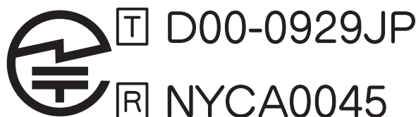
図2. 製品に付けられた技術適合証明表示 左側の郵便マークを丸で囲んだのが認定マークであり, JATE あるいは TELEC の認定番号とともに表示する義務がある。“ T ” は JATE の認定番号を意味し, “ R ” は TELEC の証明番号を意味する。この例は, JATE と TELEC の両認定を取得した場合の表記である。
