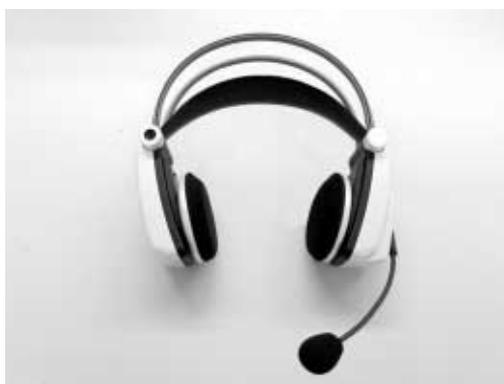
図2 . Bluetooth™ヘッドセット Bluetooth™モジュール及び電源を内蔵し ,単体で音声の送受信を行うことができる。
