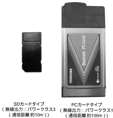
図7. Bluetooth™カードの概観比較 SD I/Oカードタイプは、大幅に小型化された。 Comparison of Bluetooth™ cards
