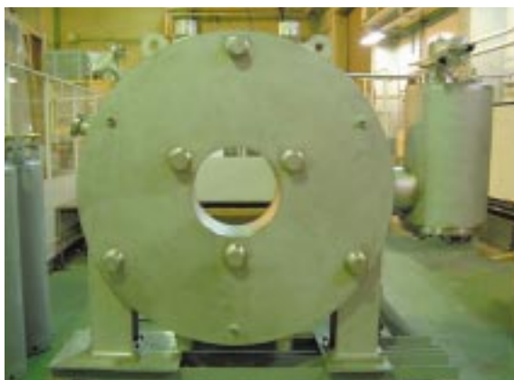
Si単結晶引き上げ用高温超電導マグネット High- T_c superconducting magnet for Si single crystal growth
