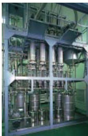
PCB無害化処理実験装置
