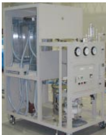
電解分離ろ過式洗濯廃液処理システム Laundry drain treatment system using electroflotation-filtration process
