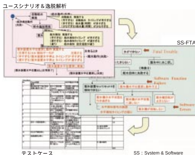
SS-FTAによるテスト項目設計の例 Example of test case design by SS-FTA
