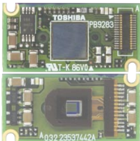
カメラモジュール基板(表, 裏) Camera module substrate (frontside and backside)
