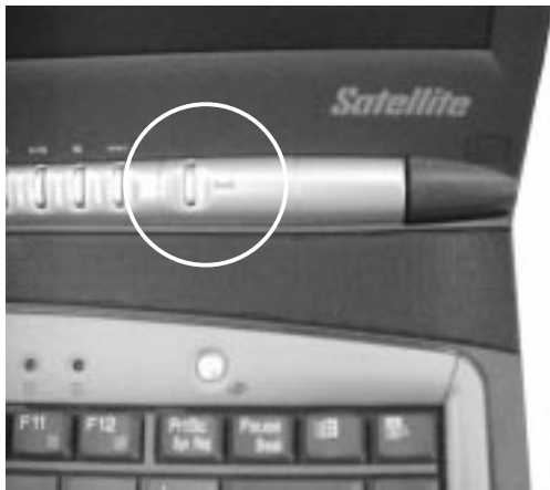
図4 . バスブーストボタン 筐体奥に、低音の音量を可変できるボタンがある。 Bass-boost button
