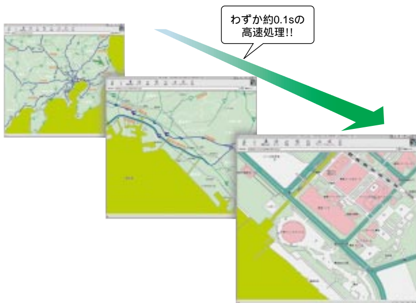
図7.地図画面の高速表示イメージ GigaBase™並びにGeoScroll™を活用することにより、地図の拡大、縮小、スクロールが非常に高速で実現可能となる。 Image of geographical data display
