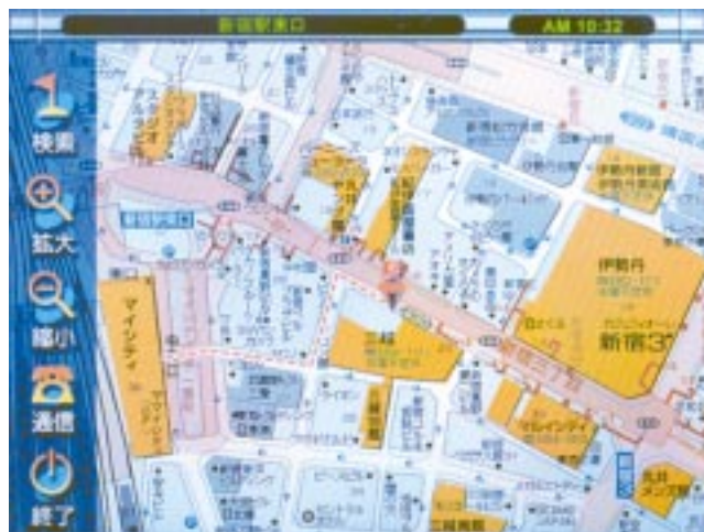
図4 . 4型VGA反射型低温p-Si TFT-LCDの表示例 バックライトを使用しない反射型表示により消費電力を1/3に低減し、また、内面反射板構造の採用により鮮明な表示を実現した。
