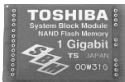
図6 . System Block Moduleの外観 四つのフラッシュメモリを搭載し、1 Gビットのメモリ容量を一つのパッケージで実現している。System Block Moduleの外形状はFBGAと同じである。
