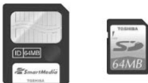
図7. スマートメディア<sup>TM</sup>とSDメモリーカード 音楽データ格納などへの対応として、スマートメディア<sup>TM</sup>(左)は、メディアごとに固有な識別番号を内蔵することで著作権保護などのシステムでの利用を可能とした。一方、SDメモリーカード(右)は、専用コントローラを内蔵することで高度なセキュリティ機能を実現している。
