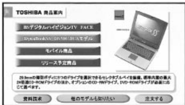
図1. データ放送の番組画面例 独立型放送の番組イメージは、文字情報と静止画を組み合わせ、更に表示切替えのボタンをはり付けている。 Example of data broadcasting service display
