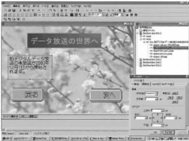
図3. オーサリングツールの画面例 半透過色での表示など、受像機と同じ見栄えでのオーサリングを実現している。
