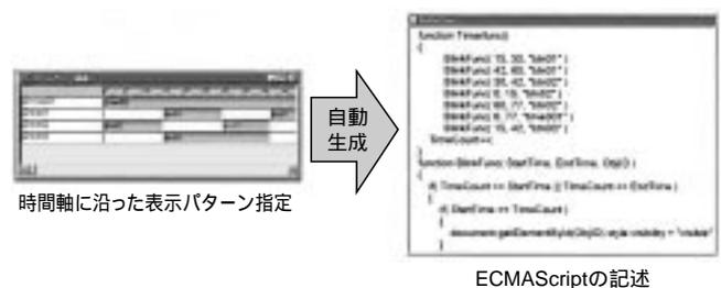
図5. スクリプトの自動生成例 GUIで設定した内容からスクリプトを自動生成している。
