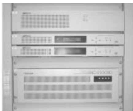
図6.映像エンコーダ 上から, HDTVエンコーダ本体, HDTV用音声エンコーダ( 2台 ), SDTV用エンコーダの順に実装されている。 Video encoder
