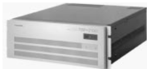
図12. ポストスプライサ 多重化装置(現用/予備)の後段に配置される。
