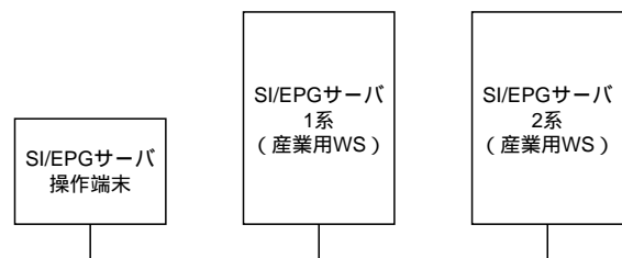
図2. ハードウェアの構成 サーバは2台のWSを使用した二重化構成である。
