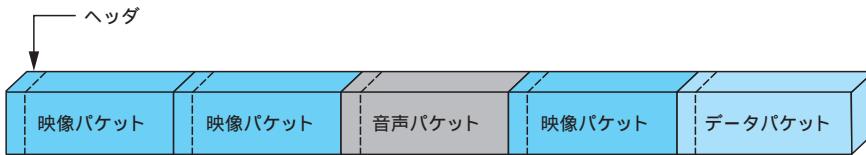
図2 . TS パケット TSを構成するパケットが流れるようすを示している。各パケットは固定長で、ヘッダに内容を示す情報が記載されている。
