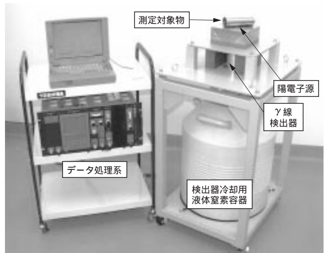
図3. 測定装置外観 テーブル状の試料ポートの中央部に陽電子源が埋め込まれており、試料ポートの上に任意の測定対象物を置くだけで、自動的に測定が行われる。
