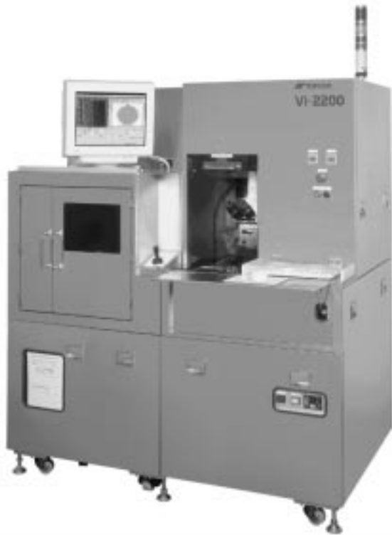
図2. 装置の外観 5 \mu m以上の欠陥を約14min(6インチウェーハ)で検出する。写真はカセット供給式のフルオートタイプ(株)トプコン提供。
