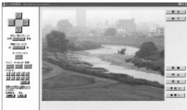
図5 . CCTVカメラによる監視・制御画面 カメラの遠隔制御を行うことができる。
