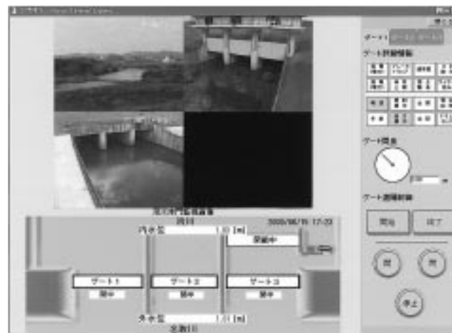
図4. ゲート監視・制御画面 水位などの各種データや映像で状況を確認し,ゲート制御を行うことができる。 Gate supervisory control display
