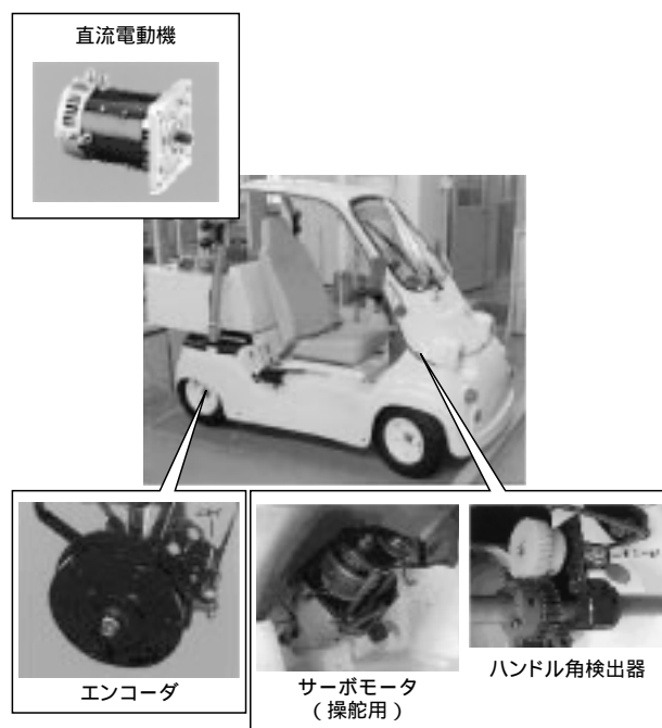
図6. 自動走行モデル車両 自動走行用に改造した車両を示す。 Vehicle with automatic speed and direction control
