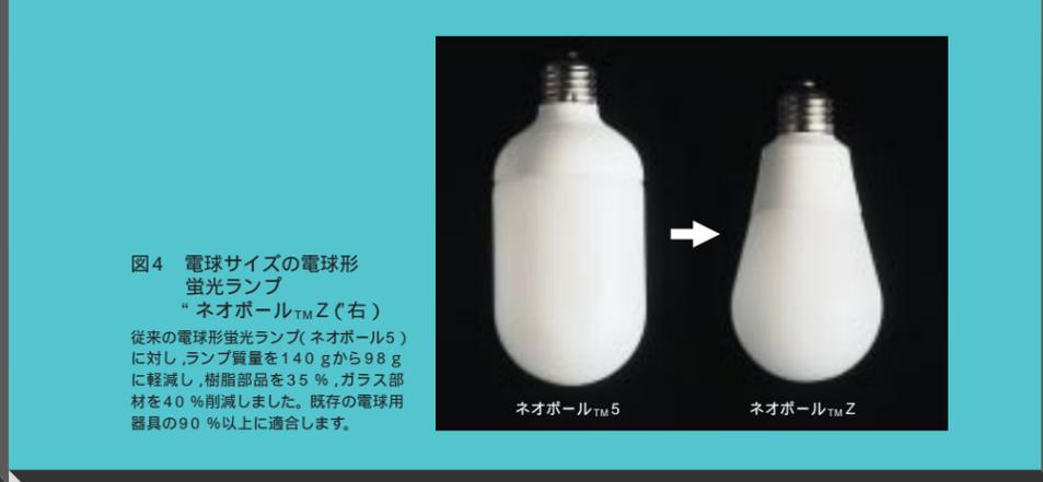
蛍光灯の欠点である形状の大きさを克服し、80年に世界初の電球形蛍光灯「ネオボール<sup>TM</sup>」を商品化しました。これは、3か所に屈曲点を設けコンパクト化した蛍光灯に点灯回路を一体化し、電球用口金を取り付け、電球器具にそのまま装着・点灯できるようにしたものです。その後、新蛍光体の採用、水銀蒸気圧制御手段の開発、ガラス接合技術の向上などの改良を蛍光管に加え、ランプ内に内蔵される安定器を電子化し、いっそうの高効率化とコンパクト化を進めました。しかし、ランプサイズが課題で、約半数の電球用器具には使用できませんでした。
