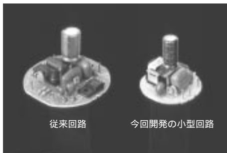
図4．回路の小型化 回路方式の簡素化と裏面実装化(SMD)により、回路の大幅な小型化を実現した。 Miniaturization of the circuit
