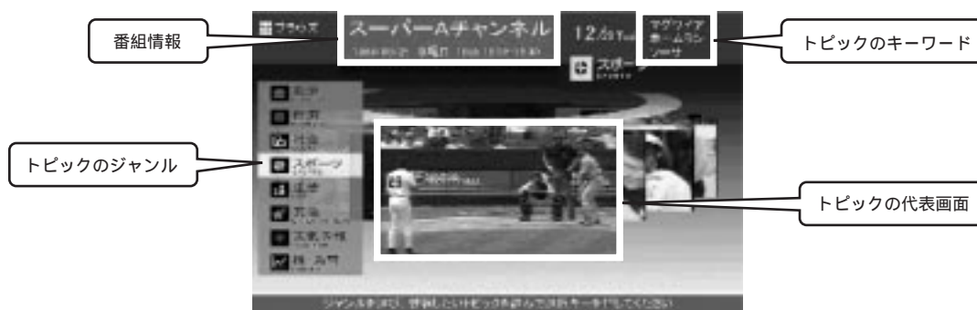
図3．番組ブラウザの表示例 正面に表示したトピックに対して各種情報を表示する。 Example of navigation system display
