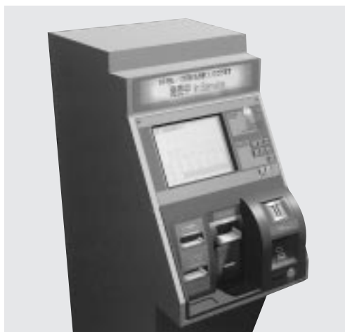
図1. 自動マルチ発行処理機 複数券種の発行機能を備えたマルチ対応券売機である。
