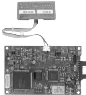
図13.微弱タイプリーダー/ライタ カード搬送機器に組み込み、無免許で利用できる。
