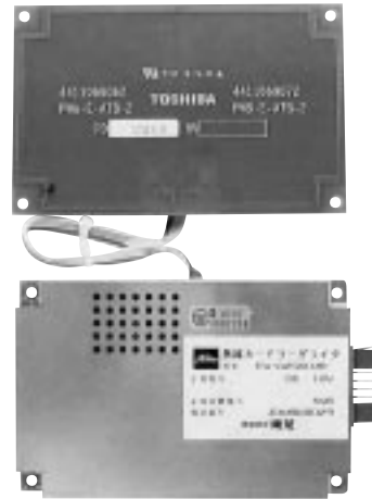
図12.1Wタイプリーダー/ライタ カードを10cm離れてかざし、利用できる。
